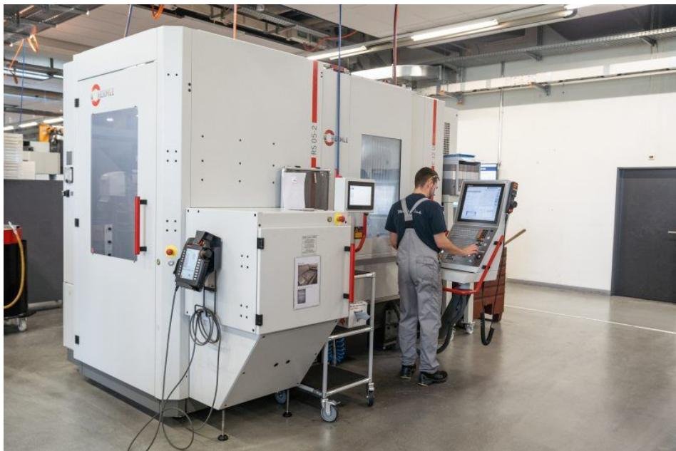
Das kompakte CNC-Bearbeitungszentrum mit Robotersystem bietet hohe Produktivität auf kleinem Raum (Bild: Hermle).
