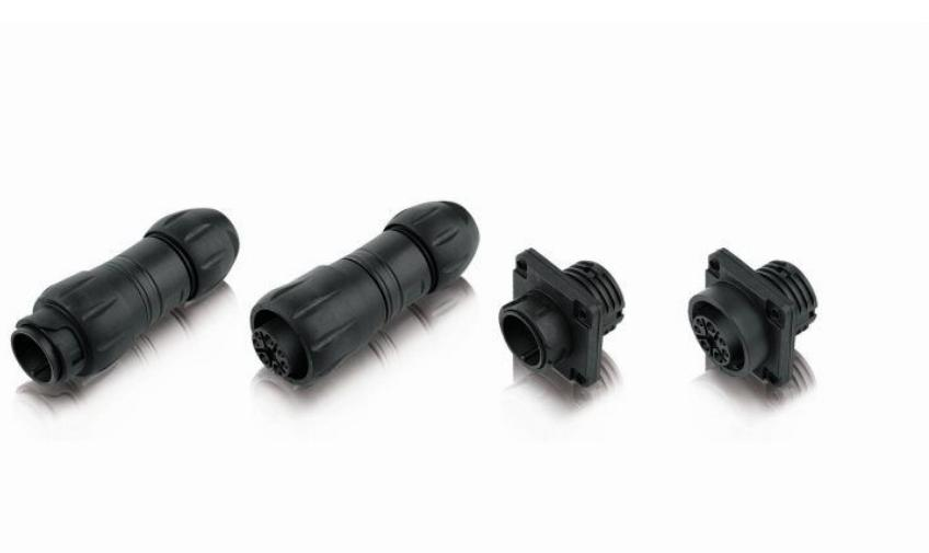
Die Steckverbinder der Serie »HEC 696« wurden speziell für raue Umgebungen entwickelt und sind als Vierkant-Flansch- sowie Kabelausführungen mit integriertem Schutzschlauch erhältlich, der Kabel bis IP67 und im gesteckten Zustand bis IP69K schützt (Bild: binder).
