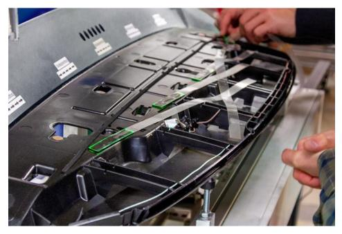
Aufbringen von Etiketten mit Laserprojektion (Bild: Z-Laser).
