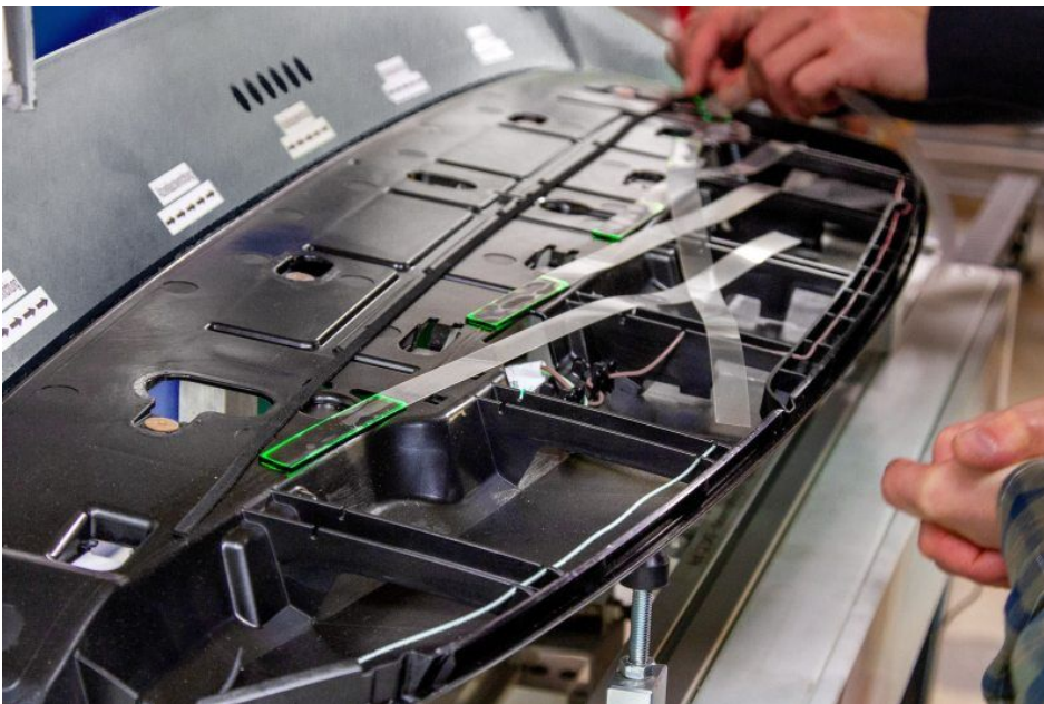
Aufbringen von Etiketten mit Laserprojektion (Bild: Z-Laser).
