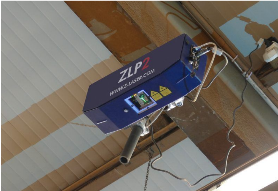
Laserprojektor »ZLP2« mit Deckenmontage (Bild: Z-Laser).
