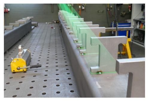
Laserprojektoren unterstützen das Schweißen, indem sie beim Anheften von Bauteilen die exakte Zielposition anzeigen (Bild: Z-Laser).
