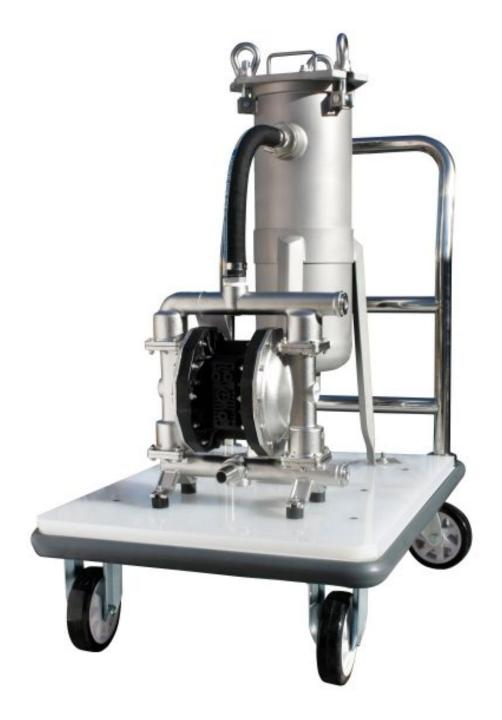
Die mobile Pumpen- und Filteranlage besteht aus einer druckluftbetriebenen Doppelmembranpumpe und einem Metallfiltersystem aus Edelstahl mit Metallinnenkorb und Filterbeuteln (Bild: Jessberger).
