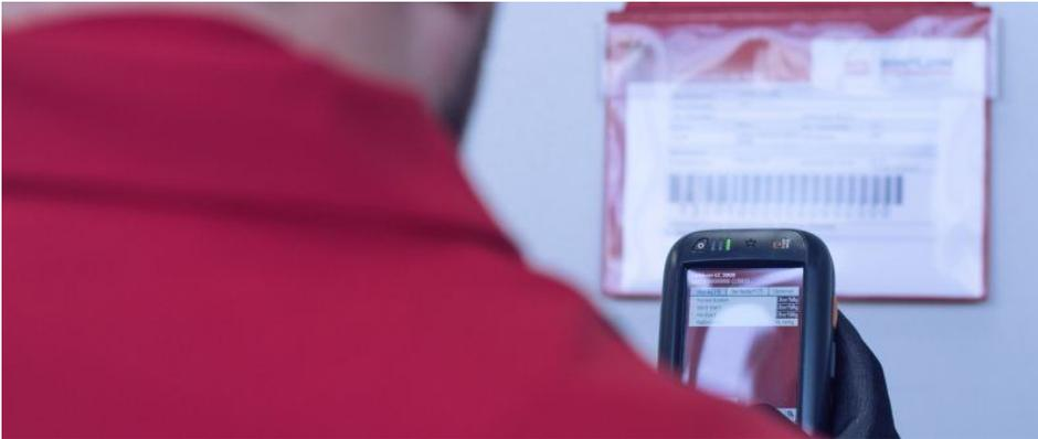
Erfasst werden alle Daten über einen Handheld-Computer, die Datenübertragung erfolgt über einen Bantleon-Server an autorisierte Empfänger (Bild: Bantleon).
