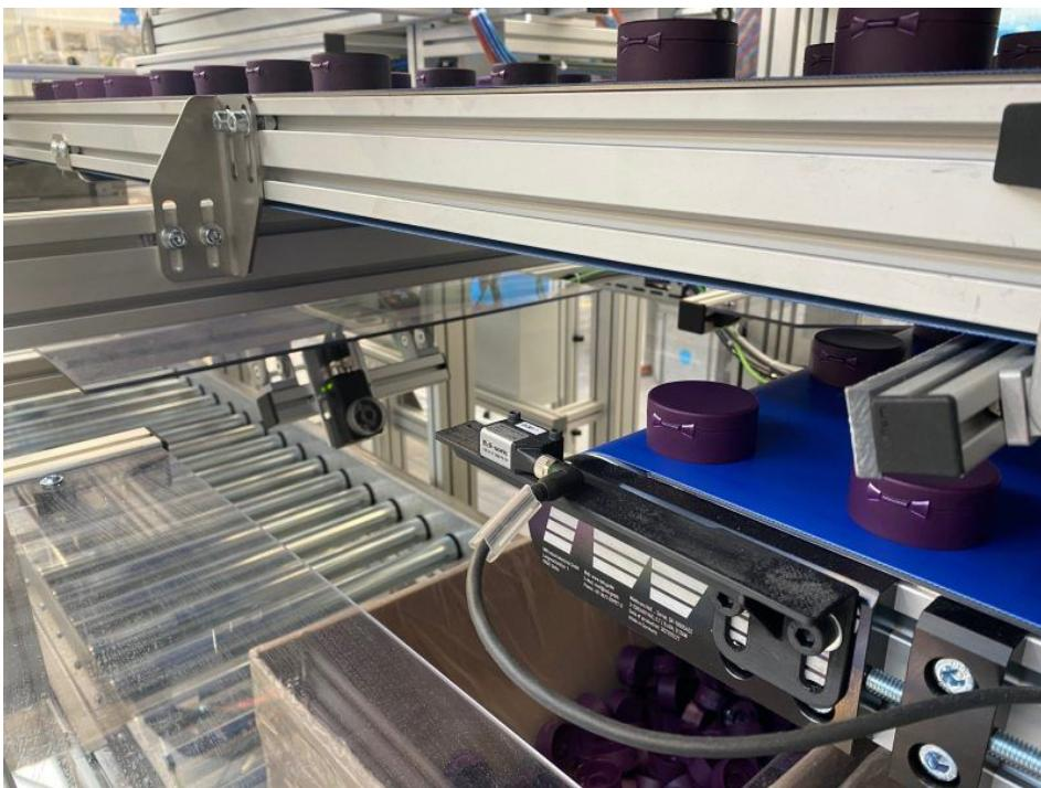
Die Reflexionslichtschranke löst die Hochleistungsbeleuchtung des Vision-Sensors aus:
