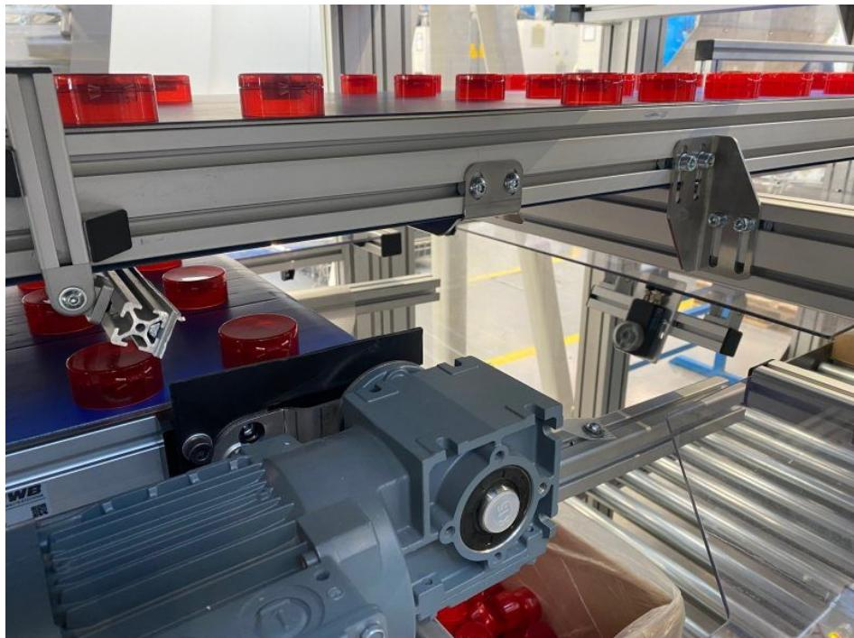
Die Verschlusskappen erreichen in Reihe das Bandende, werden vom Vision-Sensor erfasst, gezählt und fallen anschließend in den Karton (Bild: di-soric).
