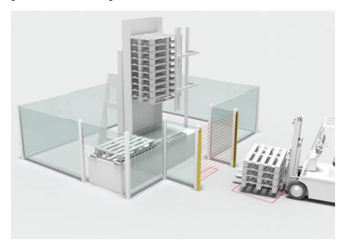
Der Zugangsbereich wird durch einen Sicherheitslichtvorhang gesichert, zusätzlich sind vor und hinter dem Sicherheitssensor Induktionsschleifen in den Boden eingelassen. So kann das Sicherheitssystem zwischen Gabelstapler und Personen unterscheiden. Die Sicherheitslösung zur Zugangssicherung an Palettenmagazinen mit automatischem Wiederanlauf wird als sicherheitstechnisch geprüftes und validiertes Gesamtpaket angeboten (Bild: Leuze).
