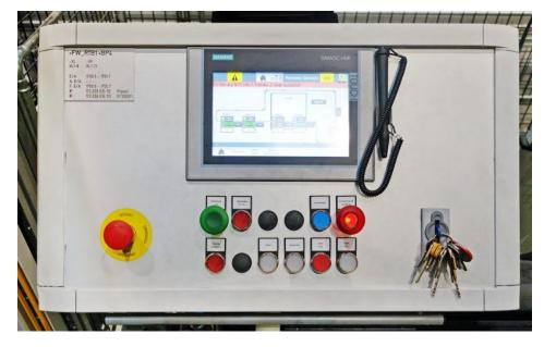
Blick auf das Bedienpult mit »Electronic-Key« in der »EKS«-Schlüsselaufnahme (Bild: Euchner).
