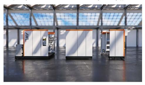
Die verschiedenen Maschinenmodule lassen sich zu einer kompletten Produktionsstrecke kombinieren. Das Projekt beweist, wie modulare Maschinenkonstruktion Flexibilität schafft und Durchlauf- sowie Inbetriebnahmezeiten verkürzt (Bild: Turck).
