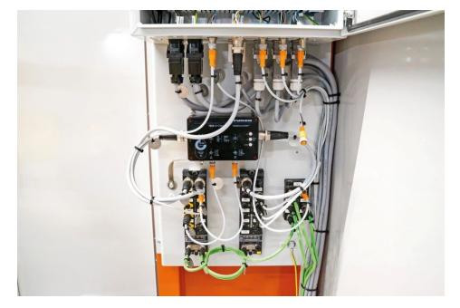
Die gesamte Sicherheitstechnik des Moduls läuft über das hybride Safety-I/O-Modul (unten links). Der IO-Link-Master (unten Mitte) wird durch die Safety-Box (Mitte) versorgt und kann so sicherstellen, dass alle Aktoren an den Class-B-Ports im Notfall abgeschaltet werden (Bild: Turck).
