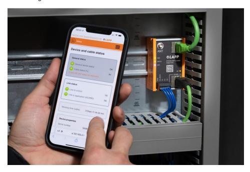
Das stationäre Überwachungsgerät wertet die aktuelle Leistungsfähigkeit einer Datenleitung aus und gibt sie in Prozent an. Der Kabelstatus kann abgelesen, über Web-Interface abgerufen oder über MQTT an die Steuerung übermittelt werden (Bild: Lapp).
