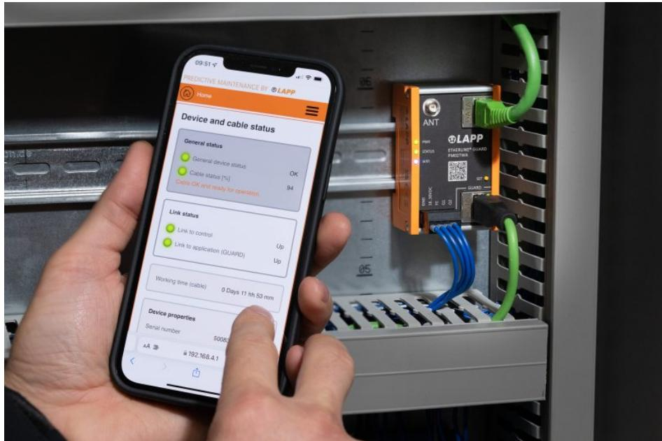
Das stationäre Überwachungsgerät wertet die aktuelle Leistungsfähigkeit einer Datenleitung aus und gibt sie in Prozent an. Der Kabelstatus kann abgelesen, über Web-Interface abgerufen oder über MQTT an die Steuerung übermittelt werden (Bild: Lapp).
