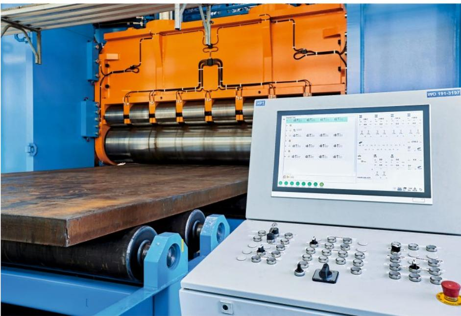
Über das im Bedienpult integrierte Multitouch-Control-Panel lässt sich der Prozessablauf übersichtlich visualisieren (Bild: Beckhoff).
