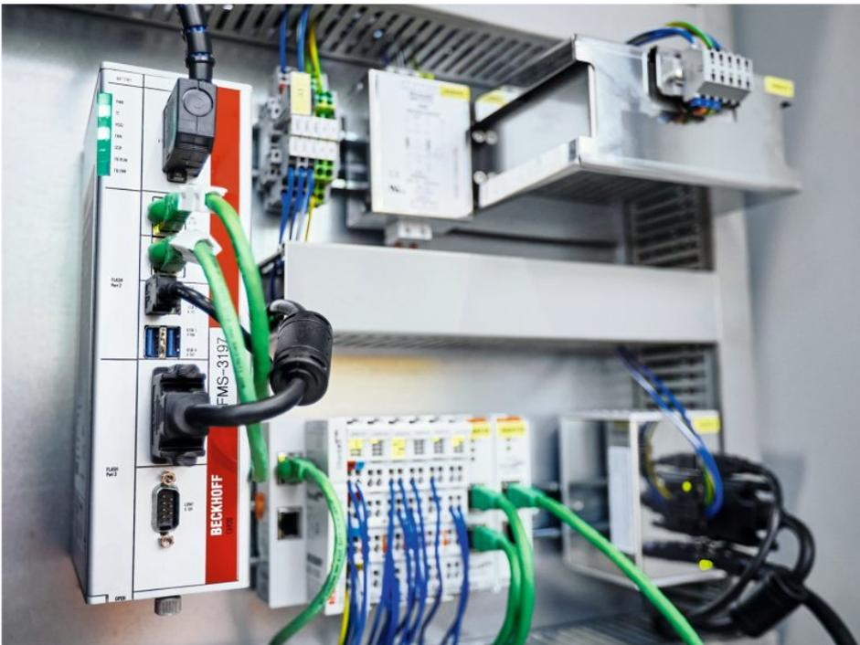
Der Industrie-PC »C6920« kommt in zwei Maschinenschaltschränken zum Einsatz (Bild:
