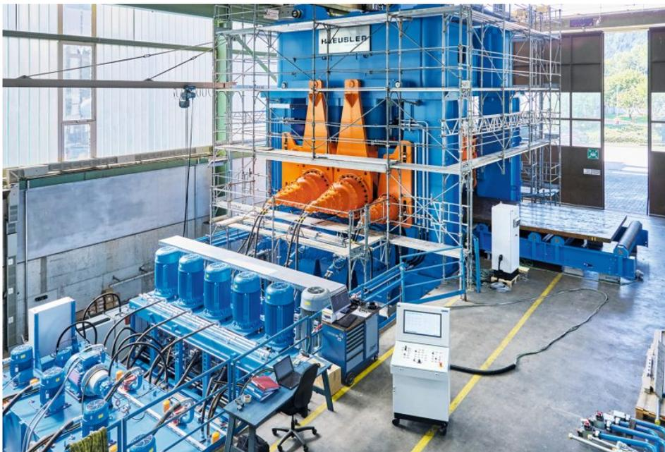
Die zwölf Meter hohe Umformmaschine mit PC-basierter Steuerungstechnik kurz vor der Auslieferung (Bild: Beckhoff).
