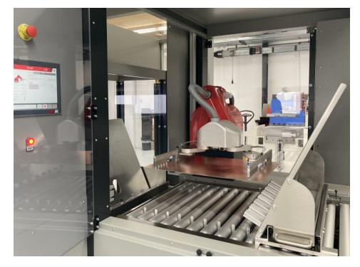
Eine der neuesten Maschinen zum universellen Be- und Entladen der rohen Kupferplatten in der Leiterplattenfertigung ist bereits serienmäßig mit dem »myPNOZ«-Sicherheitsrelais und mit Sensorik von Pilz ausgerüstet (Bild: Pilz).
