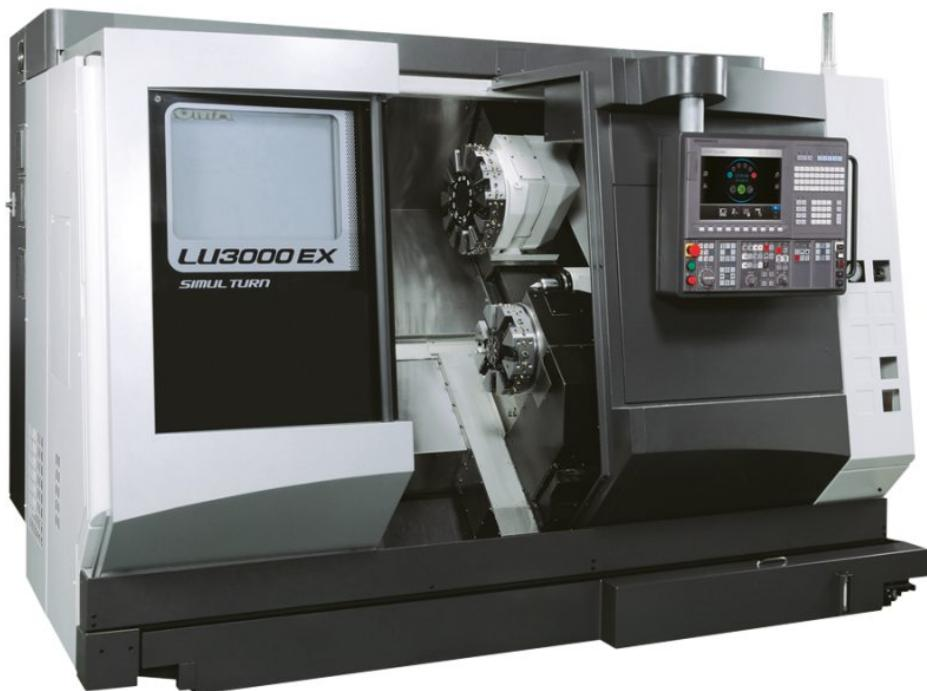
Ein »AMB«-Highlight ist die neue Werkzeugmaschine für simultanes 4-Achsen-Drehen (Bild: Okuma).
