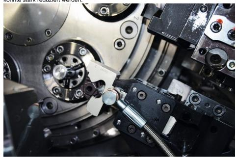
Hawe Hydraulik erzielte mit der Sonderstechplatte Prozessvorteile bei der Bearbeitung von Reglerkolben aus Einsatzstahl (Bild: Iscar).
