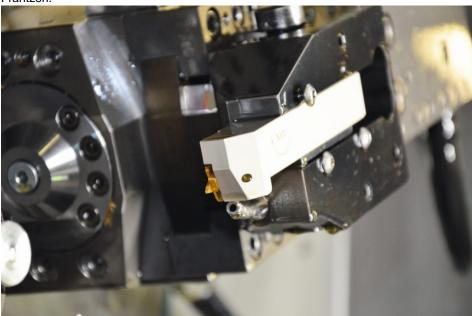
Mit »Penta Cut 17« für die Bearbeitung von Kleinbauteilen konnte Phiesel Dreh- und Frästechnik die Prozesssicherheit stark verbessern (Bild: Iscar).
