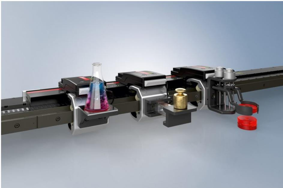
Durch die berührungslose Übertragung kann das Transportsystem als mobiles Handlingsystem eingesetzt werden (Bild: Beckhoff).
