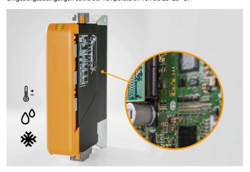
Eine spezielle Beschichtung der Elektronik ermöglicht den Einsatz unter aggressiven atmosphärischen Umgebungsbedingungen und bei Temperaturen von bis zu -25 °C (Bild: B&R).
