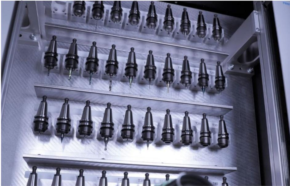
Der Werkzeugspeicher des kompakten Präzisionsbearbeitungszentrums lässt sich auf bis zu 200 Plätze erweitern (Bild: Zorn).
