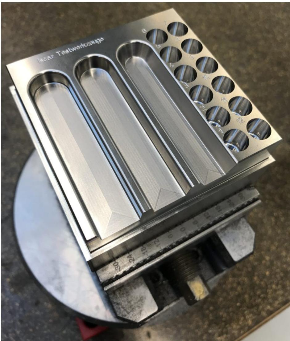
Bei Praxistests in 1.2379 durchgehärtet auf 60 HRC konnten die Mini-Fräser für die Hartbearbeitung überzeugen (Bild: Iscar).
