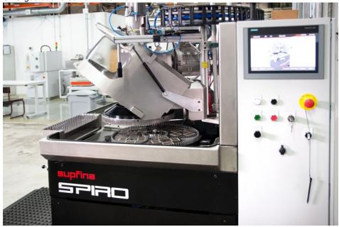
Die Feinschleifmaschine sorgt im Einsatz bei TDK für einwandfreie Kontakte der Mikro-Induktivitäten (Bild: Supfina).
