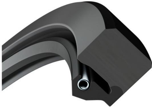
Beispiel eines weiterentwickelten Gummi-Wellendichtrings mit zwei unterschiedlichen Elastomerhärten (Bild: SKF).
