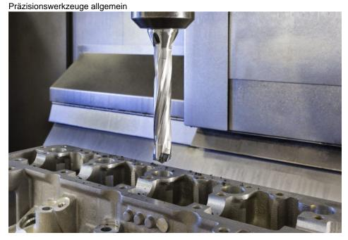
Die Bohrer verfügen über auswechselbare Köpfe mit drei Schneiden, was die Zykluszeiten um bis zu 50 % verkürzt (Bild: Iscar).
