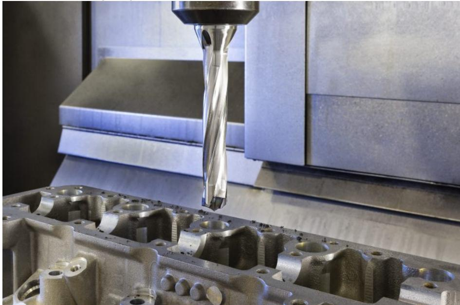
Die Bohrer verfügen über auswechselbare Köpfe mit drei Schneiden, was die Zykluszeiten um bis zu 50 % verkürzt (Bild: Iscar).
